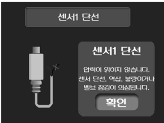
**원인:** 마스터 모드에서만 발생하며 단자대의 AD1+와 AD1-에 센서가 연결되지 않은 경우, 센서의 두 가닥 선 중에서 한 가닥이 끊어지거나 연결이 안된 경우, 센서의 불량인 경우, IO B/D의 14핀 케이블(전선)이 연결이 안되었거나 접촉 불량인 경우, 센서의 케이블의 결선이 잘못된 경우 등 다양한 원인이 있을 수 있습니다.
