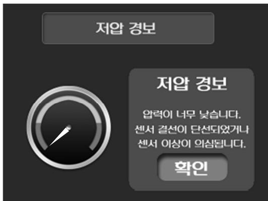
**원인:** 토출부 물이 완전히 빠진 상태에서 펌프를 기동시 압력을 끌어올리는 속도가 느려서 발생, 흡입측 저수위로 인해 발생, 펌프에 공기 유입으로 인한 발생, 하한 압력의 설정이 너무 높아서 발생, 토출부 사용 유량을 흡입부에서 공급하지 못할 정도로 많을 경우등 다양한 원인이 있을 수 있습니다.
