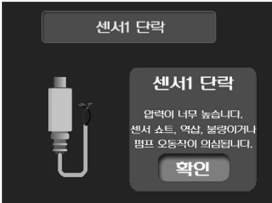
**원인:** 마스터 모드에서만 발생하며 센서의 두 선이 벗겨지거나 다른 원인에 의해 피복이 벗겨져 두 선간에 전기적으로 쇼트가 되어 발생, 또는 센서의 불량으로 인해 발생, 단자대의 AD1+와 AD1-가 전기적으로 붙어서 발생하는 경우 등 다양한 원인이 있을 수 있습니다.
